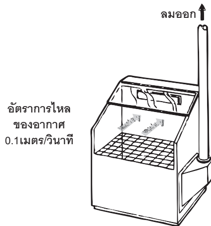
รูปที่ 3-3 การระบายอากาศและปล่องดูดอากาศ (ปล่อง/ตู้ดูดอากาศ)
