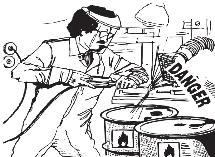
รูปที่ 2-18 ไฟที่ลุกจากการเชื่อม การตัด สามารถให้ไอของสารไวไฟ ลุกติดไฟ
